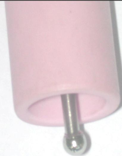
Dans tous les cas l'électrode doit conserver un aspect brillant en fin de soudage grâce à un réglage adapté du post-gaz.
