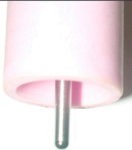
**Mauvais choix** du diamètre d'électrode par rapport à l'intensité du courant de soudage
